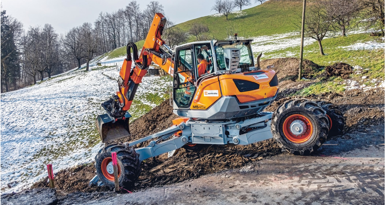
Menzi Muck M545x mit Tiltrotator Oilquick «high flow», inkl. Bohrlafette und Seilwinde
